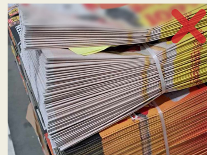
Kryssbuntning skadar trycksakens rygg. Skall buntas i trycksakens längdriktning.
